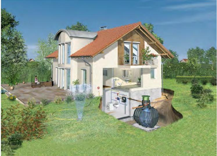
Regenwasser kann außer der Toilettenspülung auch für die Waschmaschine und für die Gartenbewässerung verwendet werden. Dies verringert die Abwassergebühr, die üblicherweise durch den Trinkwasserverbrauch verrechnet wird.
