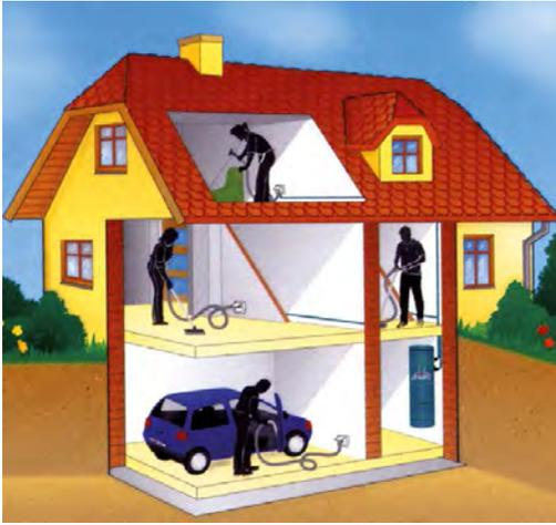
**Ein zentrales Sauggerät in einem Nebenraum und Anschlüsse im ganzen Haus sorgen für komfortable Reinigung. Vom sehr kompakten Gerät für die Außenmontage bis zur Großanlage in Gewerbebauten ist alles möglich.**
