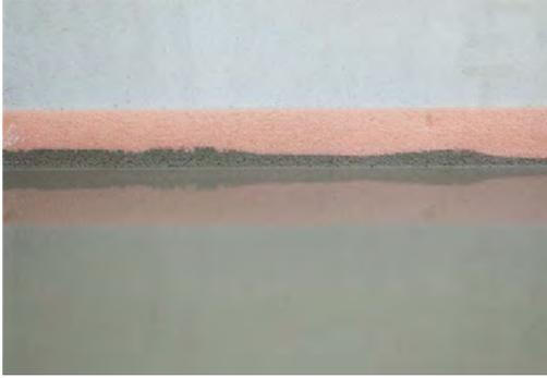
**Die Ausgleichsmasse gleicht Höhenunterschiede auf Böden (z.B. Estrich- und Betonuntergründe etc.) planeben aus. Anschließend können keramische Fliesen und Platten, Teppich und Laminatböden oder PVC-Beläge verlegt werden. Die Ausgleichsmasse ist im Innen- und Außenbereich anwendbar und auch für Fußbodenheizsysteme geeignet.**
